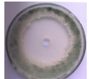
Pelėsių grybelio Aspergillus versicolor kultūra su 1 lašu „Porozid“ po to, kai ji 5 dienas laikyta inkubatoriuje 37 °C temperatūroje.
