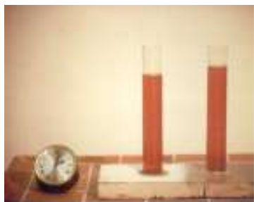
Jau po 2 valandų užfiksuota, kad kuras prasiskverbė į betoną ir kairėje pusėje esančiame vamzdelyje jo lygis nukrito.
