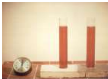
Betono plokštė, kairėje neapdorota, dešinėje apdorota „PlastaDur P“, su priklijuotais testavimo vamzdeliais, pripildytais skysto kuro EL (gazolio)
