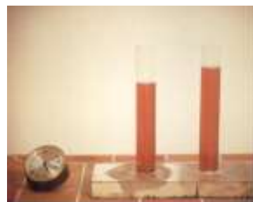
Po 5 valandų aiškiai matomi kuro nuostoliai ir ištisinis betono prisotinimas (kairėje)
